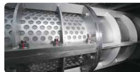
汚泥脱水機内部
