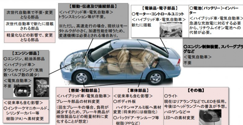
図表2-25 電動化によって影響を受ける自動車部品
