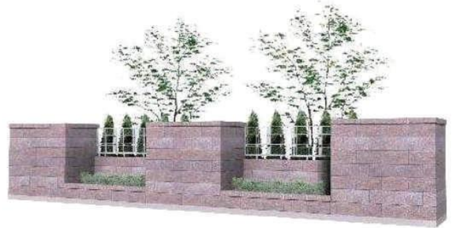
安全なブロック塀等への改修例
